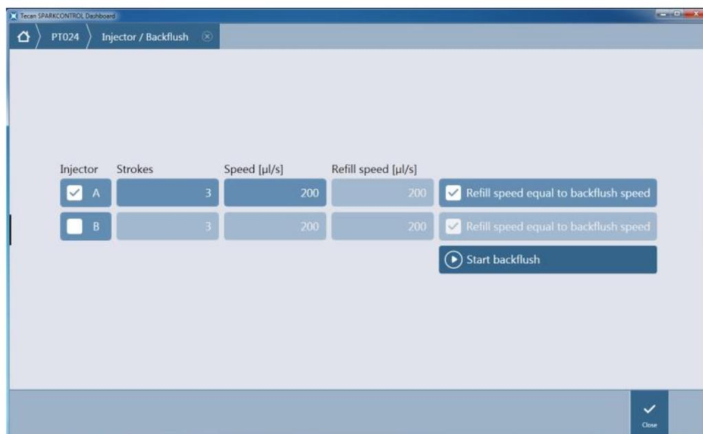
Figure 93: Backflush parameters
